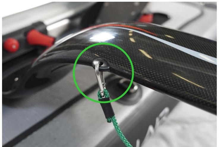
Hinweis: Der Riemen mit der grünen Verriegelungs-knopf muss sich auf Steuerbord und der Riemen mit dem roten Verriegelungsknopf auf Backbord befinden.
