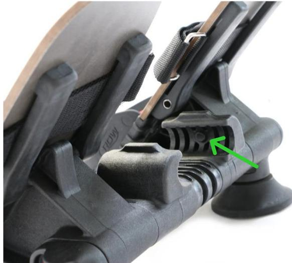
Hinweis: Beide Klemmzapfen des Stemmbretts müssen beidseitig in den seitlichen Bohrungen am Ende der Rollschiene stecken, bevor der Klemmhebel umgelegt werden kann.
