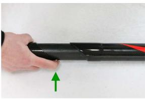
Die Rohre so ineinanderschieben, dass der Druckknopf vollständig einrasten kann.
