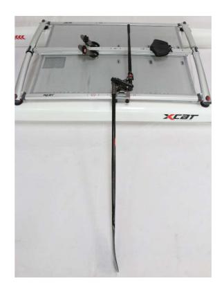
2) Das Ruderblatt bis zum Anschlag drehen. Der Winkel zwischen Boden und Ruderblatt darf 90° keinesfalls überschreiten. Optimal ist eine leichte Neigung des Blattes wie im Bild.
