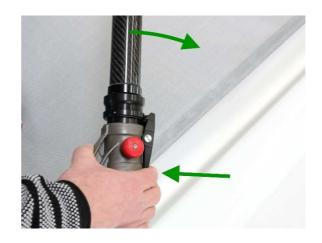
4) ... und das Griffrohr drehen, bis es parallel zum Blattrohr steht.
