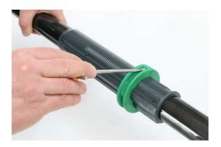
2) ... den Klemmring an die gewünschte Position schieben und die Schrauben wieder festziehen.
