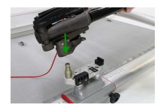
Hinweis: Das Skull muss beim Aufsetzen soweit nach innen geschwenkt sein, dass die Kante der Abziehsicherung freisteht.
