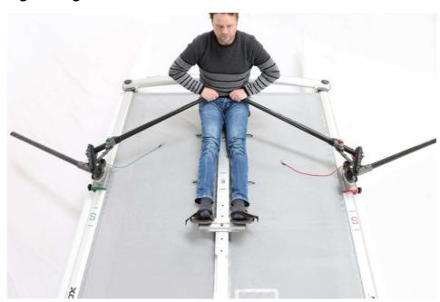
Info: Auch in der Endzugsposition ist ein Anschlag eingebaut. Wenn der Anschlag beim Rudern erreicht wird und das Blatt noch im Wasser ist, wirkt das Ruderblatt wie ein Steuerruder und man spürt einen leichten Ruck. Es ist also empfehlenswert nicht ganz bis zum Anschlag zu ziehen und das Ruderblatt beim Austritt aus dem Wasser sofort aufzudrehen. Dann bewegt sich das Blatt durch den Wasserdruck fast wie von selbst aus dem Wasser. Dabei dürfen die Griffe jedoch nicht zu stark festgehalten werden.
