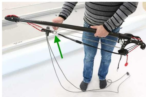
2) Bugsprit in die Nut an der Vorderseite des Mittelbalkens einhängen, ...
